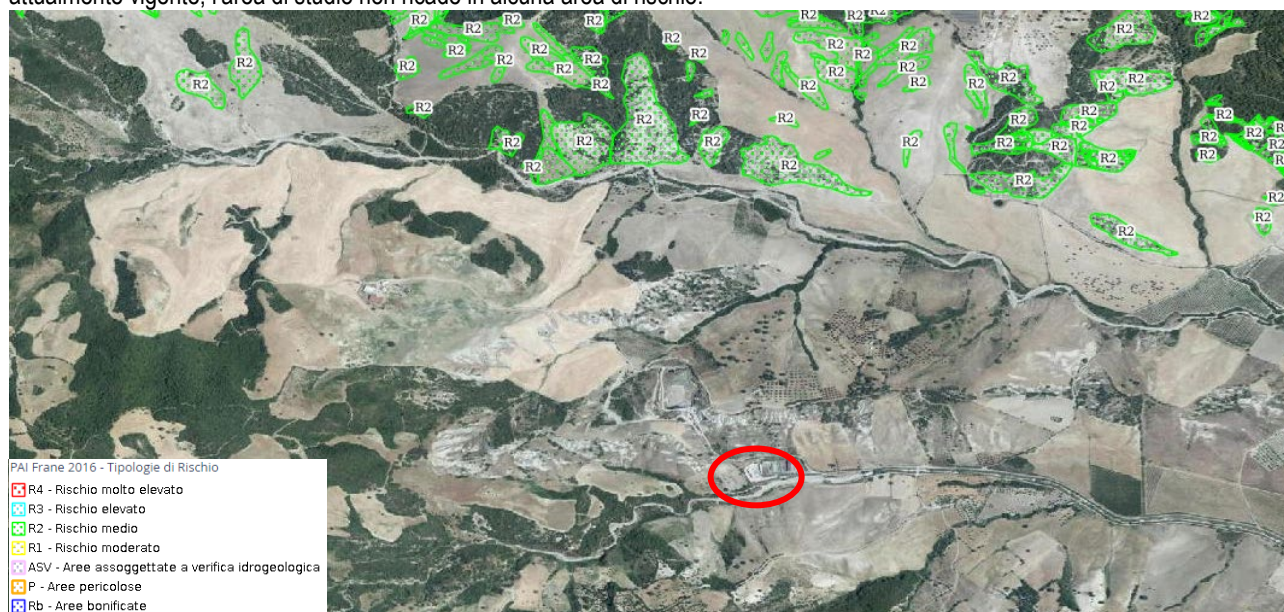
Figura 7 Figura 7 Estratto "Carta del Rischio" del Piano Stralcio per la difesa del rischio Idrogeologico dell'Autorità di Bacino (fonte: http://rsdi.regione.basilicata.it/servizi-in-linea/ )
